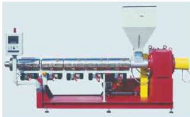
Extruder cu 5 zone de temperatură
